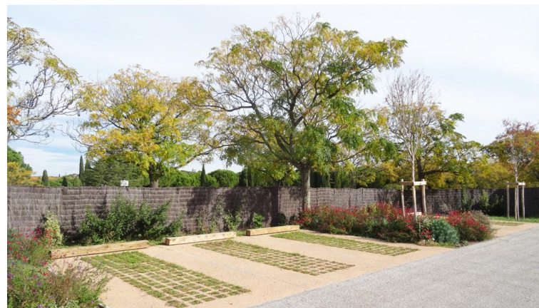
Exemples d'aménagements d'un espace de stationnement perméable
